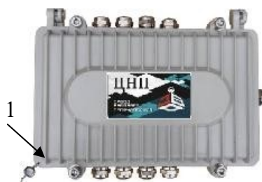
Рисунок 4 – Схема пломбировки приборов весоизмерительных (1 – свинцовая или пластиковая пломба; 2 – мастичная пломба)
