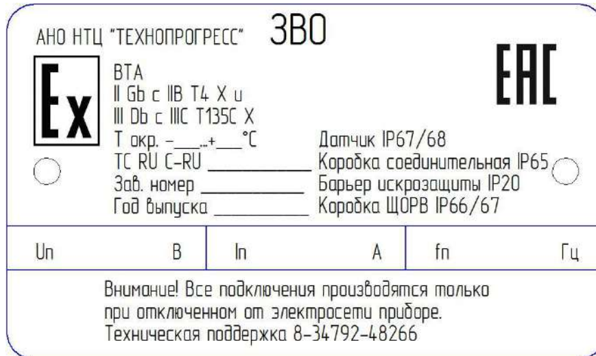
Рис. 2. Маркировочная табличка автомобильных весов, выполненных во взрывозащищенном исполнении.
