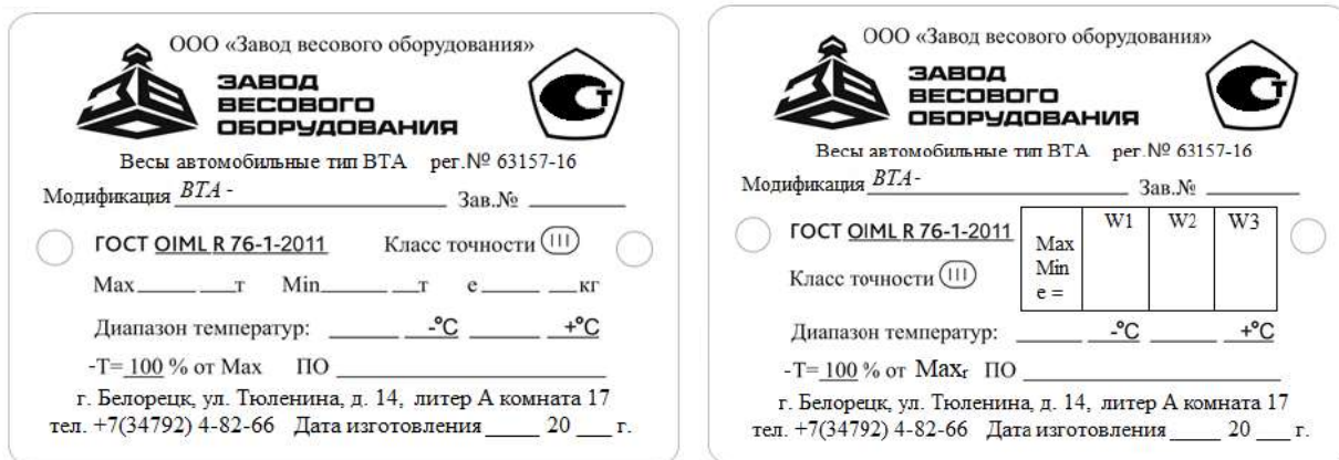
Рис.1 Общий вид маркировочной таблички однодиапазонных (слева) и многодиапазонных (справа) весов
